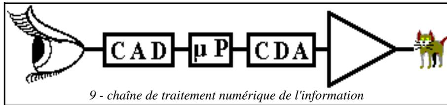
De par leur nature, les phénomènes physiques sont analogiques, et dans l'ordinateur, le traitement correspondant de l'information se fait en numérique : dans la chaîne de traitement, il faut donc procéder à deux démarches de conversion : en entrée, conversion analogique→digital ; et en sortie conversion digital→analogique.
