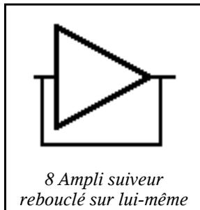
Voici, à gauche, le schéma d'une mémoire électronique bistable : Elle est construite au moyen d'un amplificateur non inverseur. Il fonctionne en suiveur : Sa sortie recopie son entrée. Au moyen d'un câblage électrique, on reboucle sa sortie sur son entrée. Alors la boucle est bouclée.
